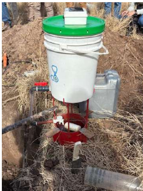
Figura 3: Equipo para medir infiltración
