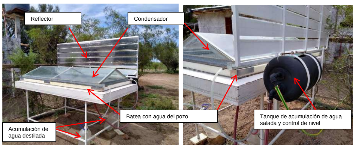
Figura 3. Foto del destilador ubicado en uno de los puestos con sus partes esenciales indicadas. Frente norte (izq.), frente sur (der.)
